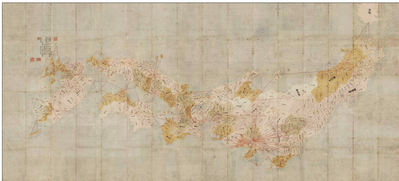
守屋壽コレクションで初めて確認された「松浦静山旧蔵日本全図(享保の日本図)」。山からの朱線が徳川吉宗の命で製作された享保の日本図の望視地点(203点)と一致する。測量図は縦152cm、横336cm、縮尺は1/216000
